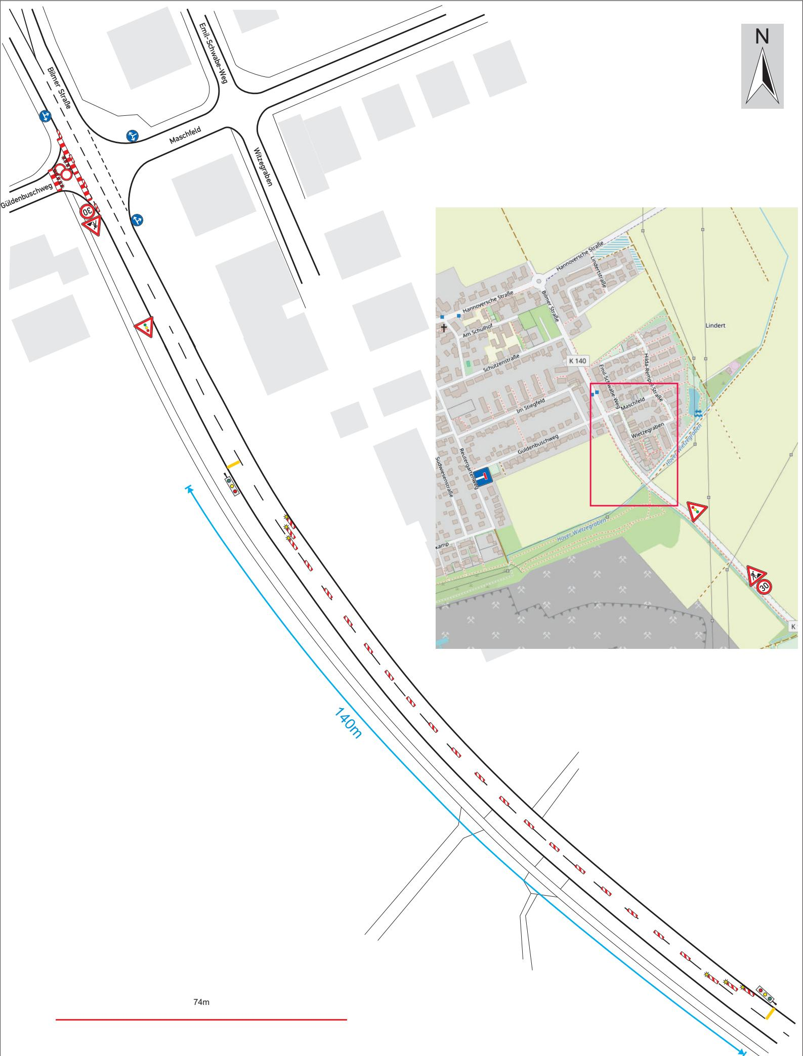
Die Montage und Demontage der mobilen LSA erfolgt analog Regelplan B II 2 der Zulassungsordnung. Für den Zeitraum ab 7 Tage vor Inbetriebnahme bzw. 7 Tage nach Ausschaltung der LSA ist der RP B IV / 2 Bestandteil der verkehrsbehördlichen Anordnung.
